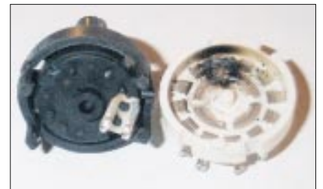
Bild 5: Infolge unzureichender Spannungsfestigkeit zerstörter Stufenschalter
