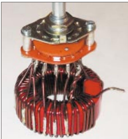
Bild 4: Stufenschalter und Schwingkreisspule fertig verdrahtet – die Koppelwicklung fädelt man erst im eingebauten Zustand durch. Die zweite Schalterebene wurde entfernt.
