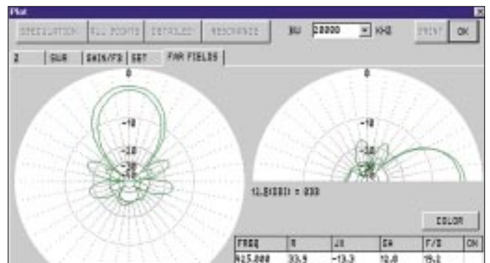
Bild 2: Simuliertes Richtdiagramm und Parameter der Antennenstruktur
