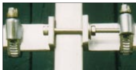
Bild 3: Schlauchschellen als Elementhalter, Ansicht von unten Fotos: DL7HG
