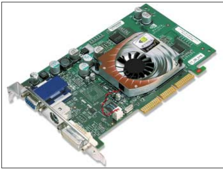
Mit dem NVIDIA GeForce4 MX460-Grafikprozessor werden auf der Grafikkarte bis zu 1,2 Milliarden Texels/s erreicht (Texturfüllungen). Foto: Werkfoto NVIDIA
